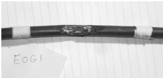
Fig. 10. Gouge on EPR specimen.
